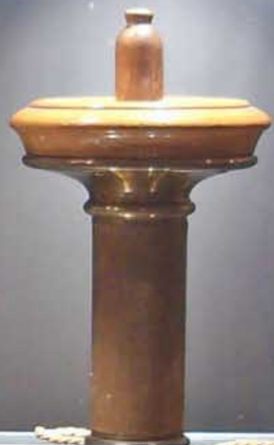
VIHELISKUTSUPUHELIN SIGNALTRUMPETTELEFON WHISTLE CALLING TELEPHONE SIEMENS & HALSKE 1878
