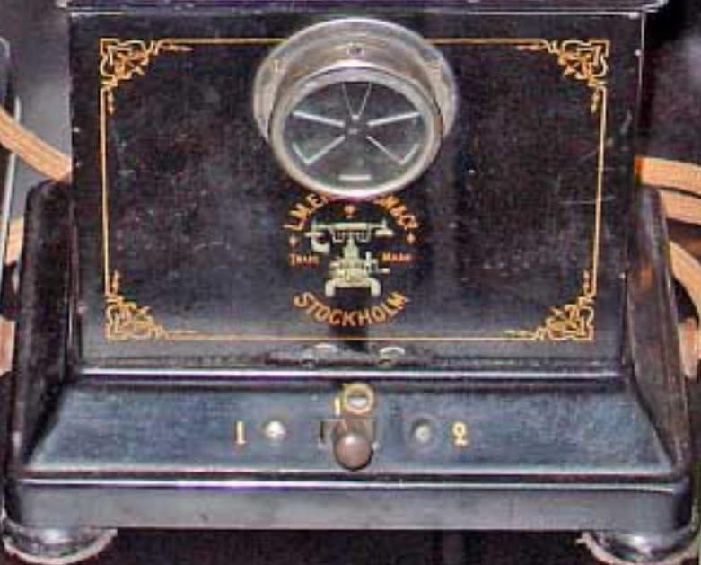
KAKSOISPUHELIN TELEFON FÖR TVÅ LINJER TELEPHONE FOR TWO LINES L.M.ERICSSON AC 400
